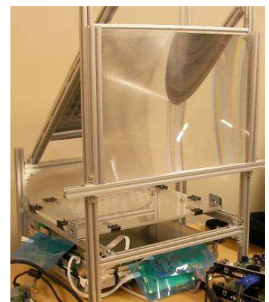
図1 CIVIの原理（左）と実際に製作したプロトタイプシステムの外観（右）。プロトタイプシステムでは、凸レンズアレイと大口径レンズの間に鏡による折り返しを入れている。
