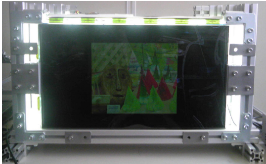
図3 時分割パララックスバリア式裸眼立体ディスプレイのプロトタイプシステム
