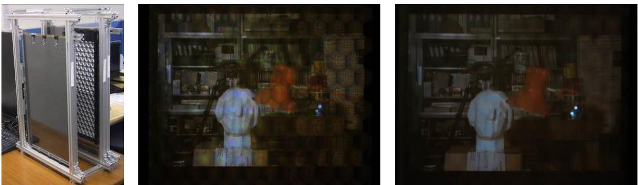
図3 製作した縦型 23 インチ裸眼立体ディスプレイ装置(左)、垂直方向拡散がない場合の立体像(中)、および垂直方向拡散を加えた場合の立体像(右)
